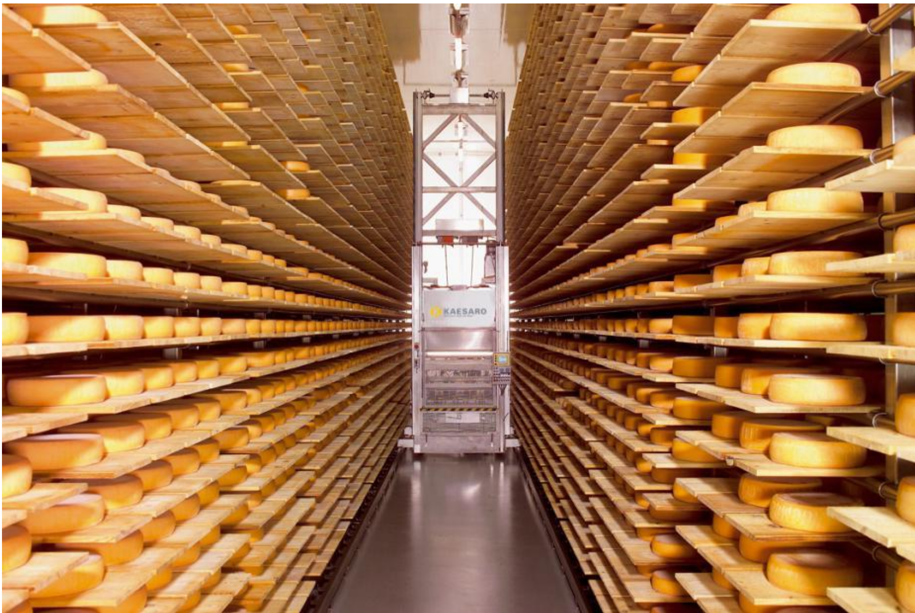
Der mobile Käseroboter fährt im Lager zwischen den Käserегalen und schmiert Käse beidseitig der Gänge
